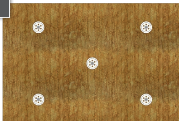
5 dyvler pr. plate = 10 dyvler/m 2
