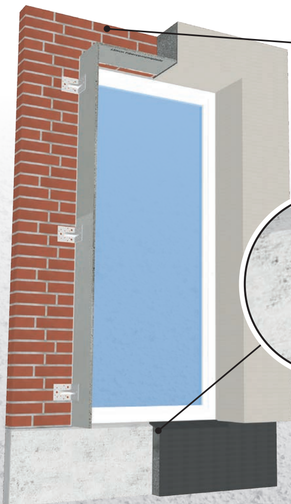
EPS-fasadeisolasjon på eksisterende bygning
