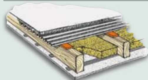
Nytt-eller renoverat bjälklag
