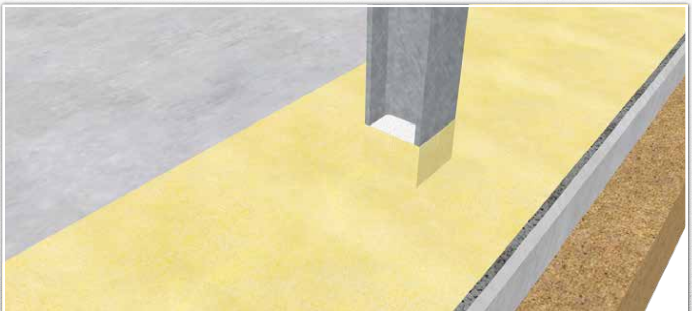
Radonsikring ved søjle i hulmur
