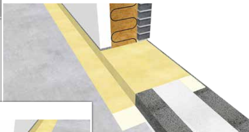
Ydervæg/fundament med terrændæk i lavere kote end overkant sokkel.
