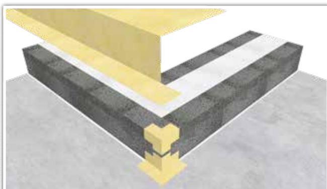
Første bane LIP Folie tilskæres og pålimes med LIP 2K.
