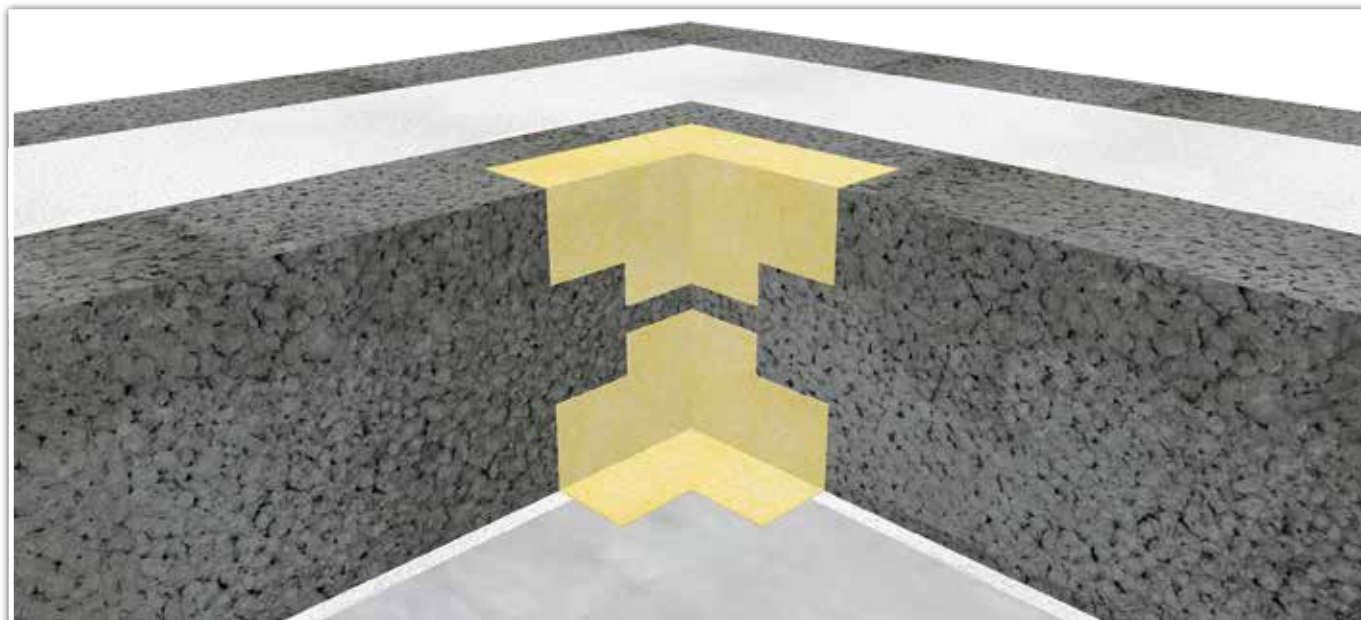
LIP Folie – indvendig og udvendig hjørne pålimes med LIP 2K.
