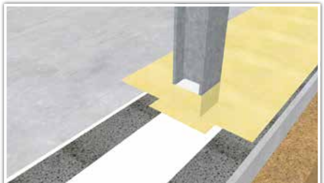
LIP Foliebaner tildannes og pålimes med LIP 2K
