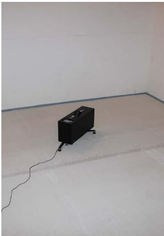
Fig. 3: Standard hammerværk på prøven
